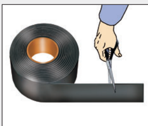
Kutting av buttskjøten
